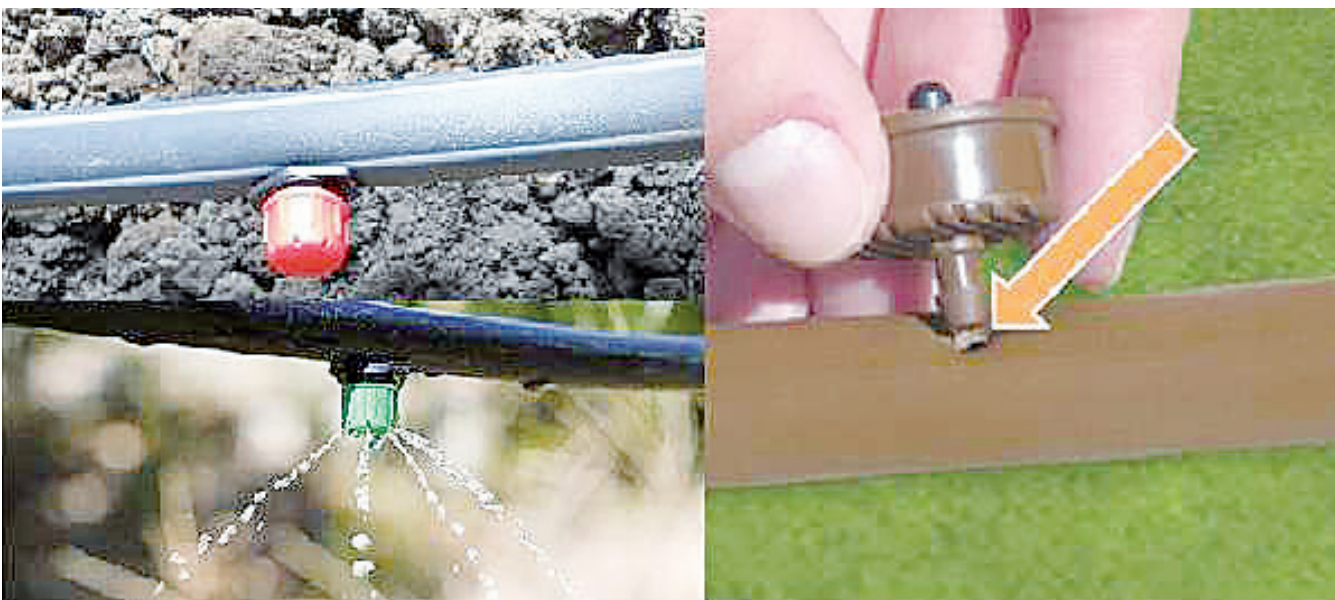
Крепление капельниц к глухой 16-мм трубке.
